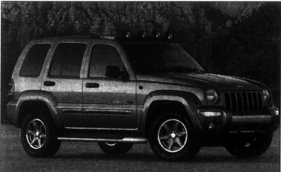
Il y a vingt ans, Jeep proposait un modèle Cherokee propulsé par un moteur turbodiesel. Cette année, le Liberty CRD marque un retour dans ce créneau avec son moteur 4 cylindres diesel de 2,8 litres développant 160 chevaux et un couple de 295 lb-pi.
