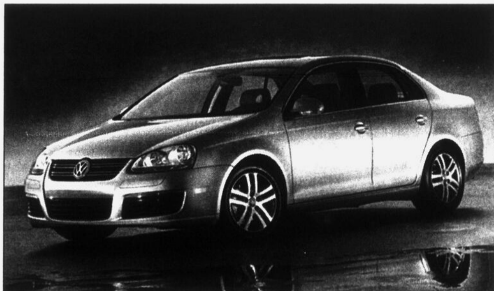
La nouvelle Jetta 2006 partage avec ses sœurs Golf et New Beetle un quatre cylindres diesel de 1,9 litre et 100 chevaux. Le nouveau système d'injecteurs-pompes appelé «Pumpe Duse» mis au point l'an dernier par les ingénieurs de Volkswagen a permis de réduire le bruit et la pollution associés à ce moteur.
