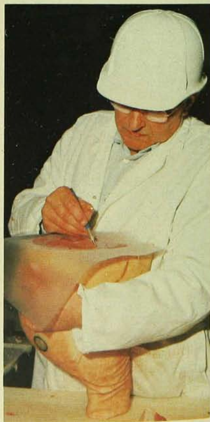
Le tracé du contour de la surface du jambon est l'une des étapes de l'analyse des proportions de viande maigre et de gras. Tous les morceaux sont codés (25 KS, 29 KS, etc.) pour identifier le producteur.
