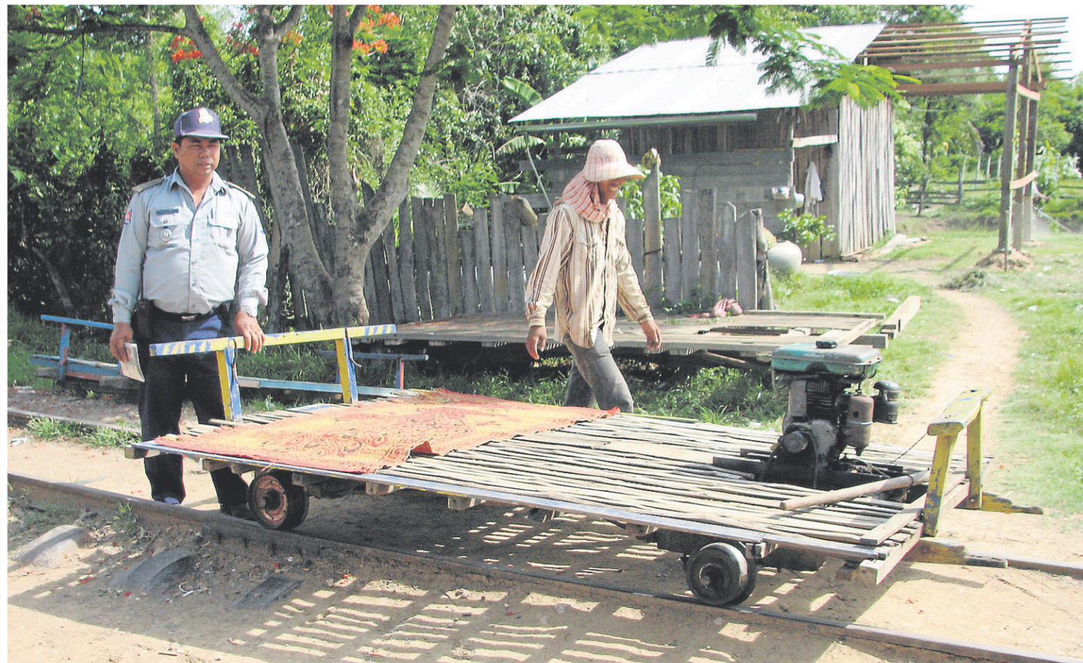
Le train de bambou consiste en une plateforme de bois sur des roues. Il est propulsé par un petit moteur à bateau. — PHOTO LA TRIBUNE, JONATHAN CUSTEAU
