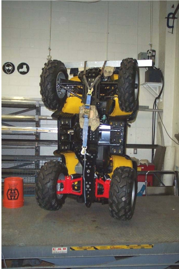
Figure 8: Pendule d'estimation de la période des oscillations autour de l'axe vertical d'un véhicule.
