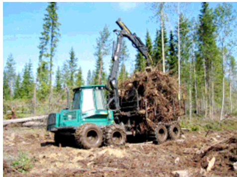
Photo 13 : Porteur de biomasse forestière résiduelle brute avec chariot de transport élargi
