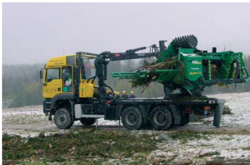
Photo 5 : Équipement de mise en fagots monté sur un camion
