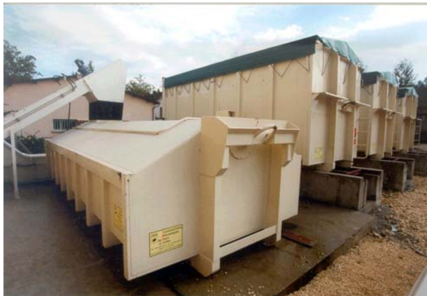
Photo 20 : Conteneurs équipés d'un système d'extraction se raccordant très facilement au système de transfert du combustible
