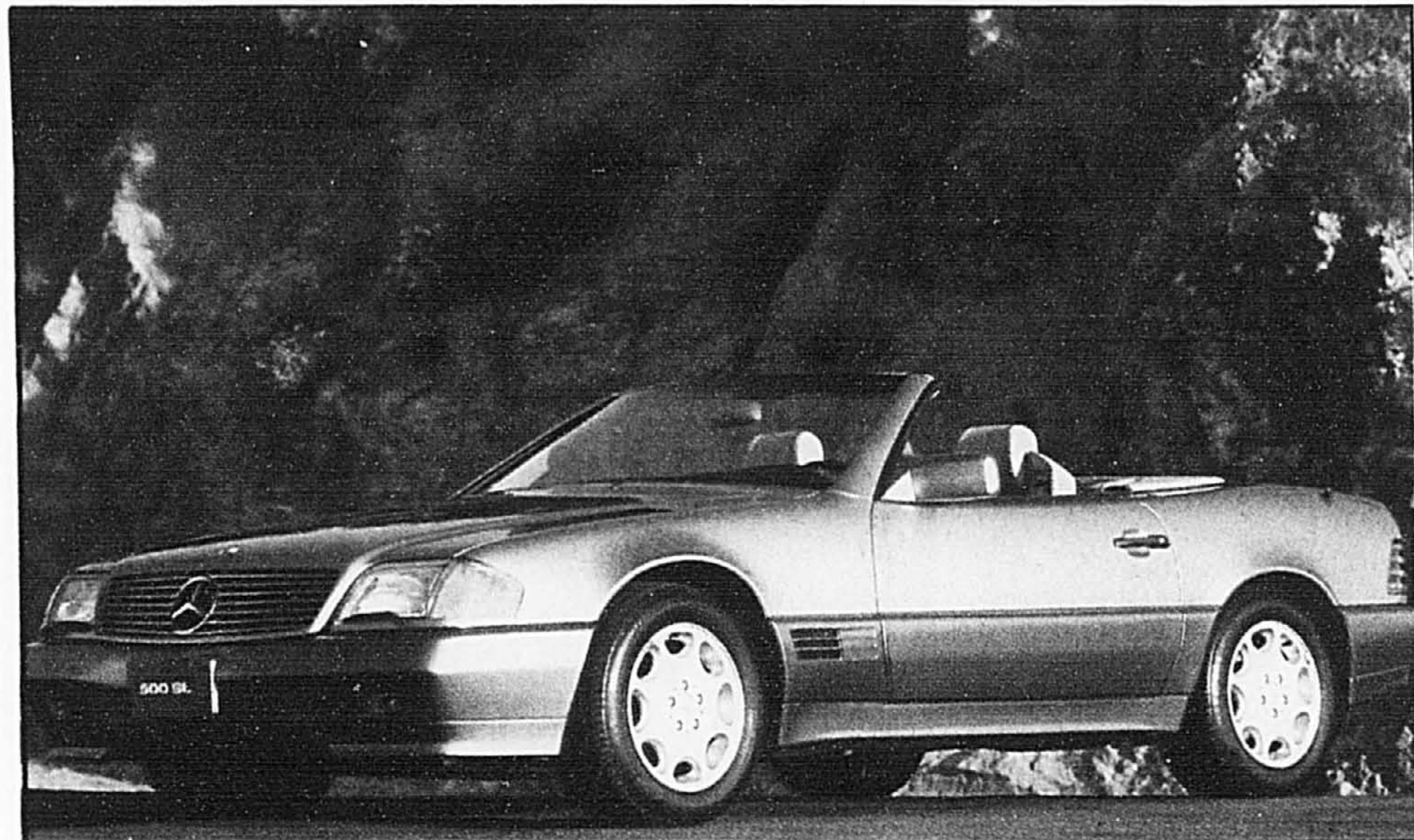
La 600 SL est certainement la plus sophistiquée des Mercedes avec sa carrosserie de cabriolet et son moteur V12 de six litres. La photo fait voir la 500, qui est identique, sauf pour le moteur qui est un V8.
