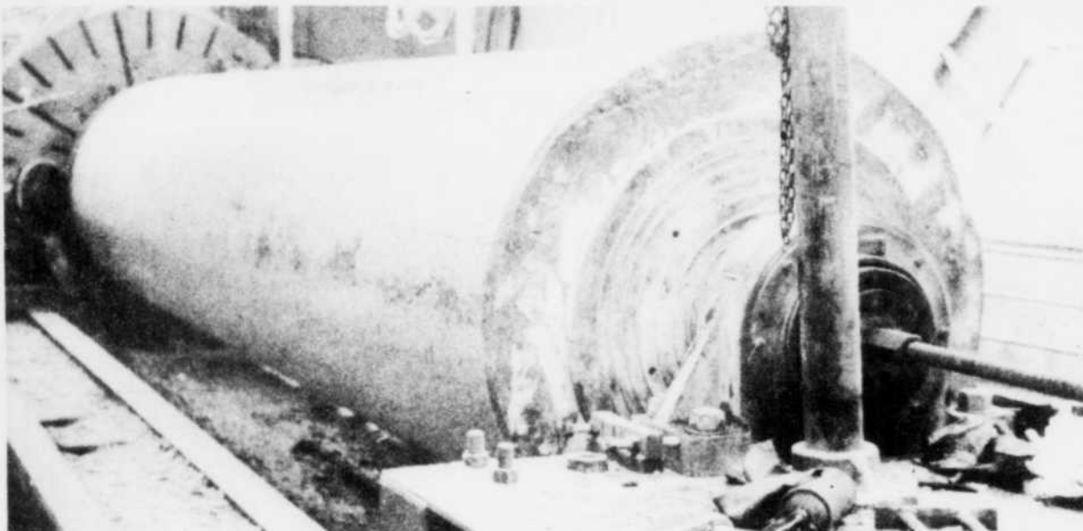
Dégrossi puis arrondi grossièrement, ce cylindre pesant une trentaine de tonnes sera poli au point que l'on pourra presque s'y mirer.
