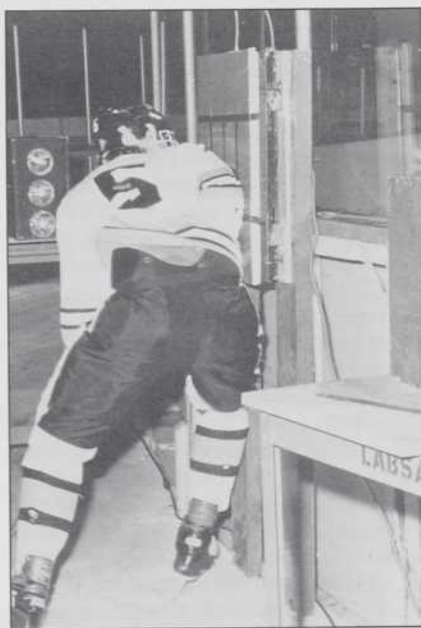
Grâce à cette plate-forme, on a pu mesurer la force déployée au cours d'une mise en échec.
