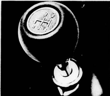
Boîte manuelle à 4 vitesses, type sport, à levier au plancher.
