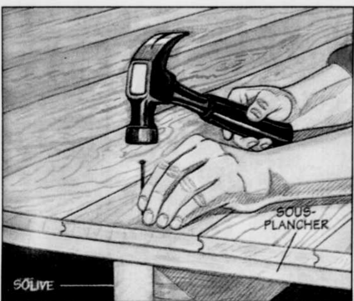
Clouage du revêtement
