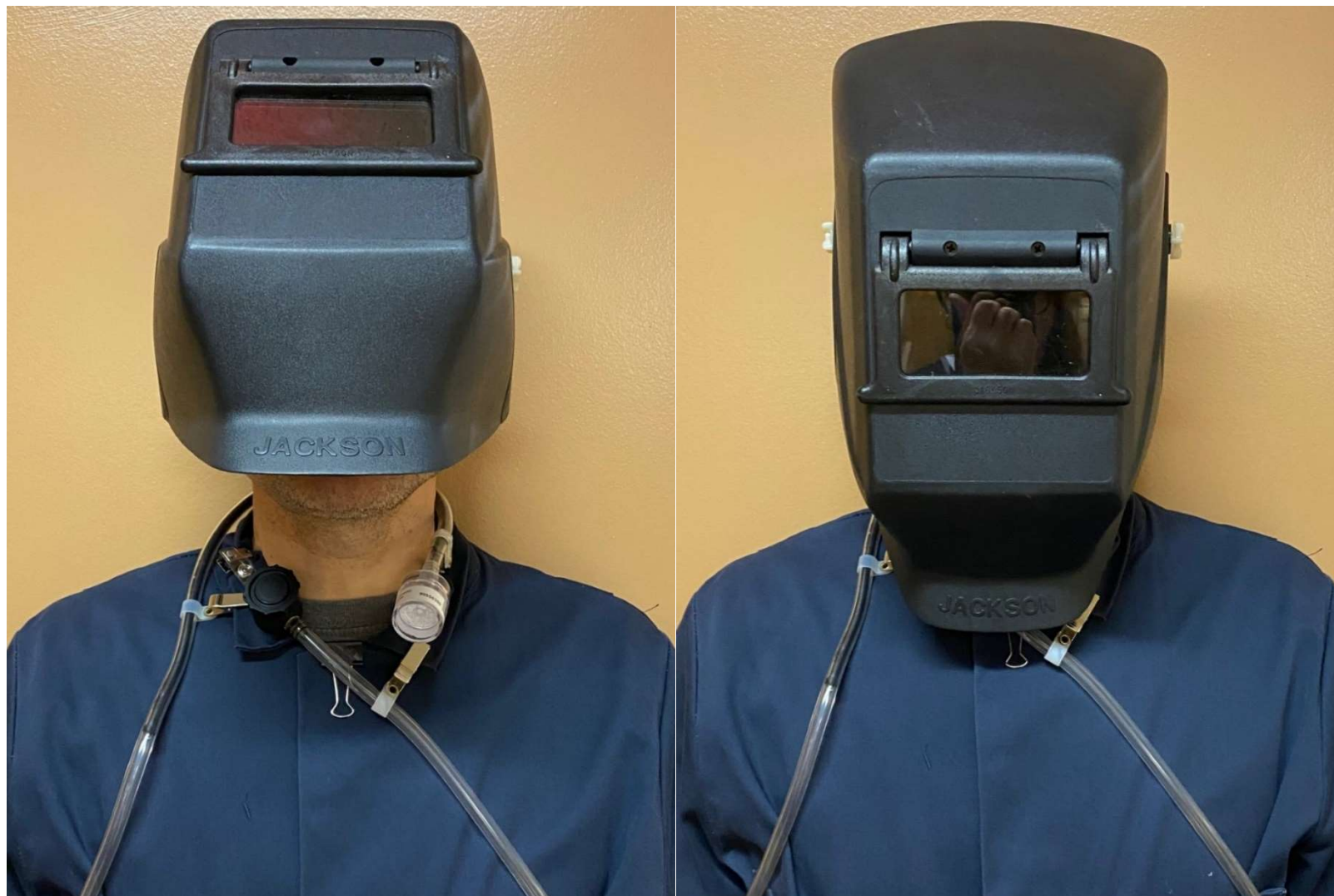
Figure 7 : Avec seulement un tube Tygon semi-rigide et un tube Tygon simple qui vont vers l'avant
