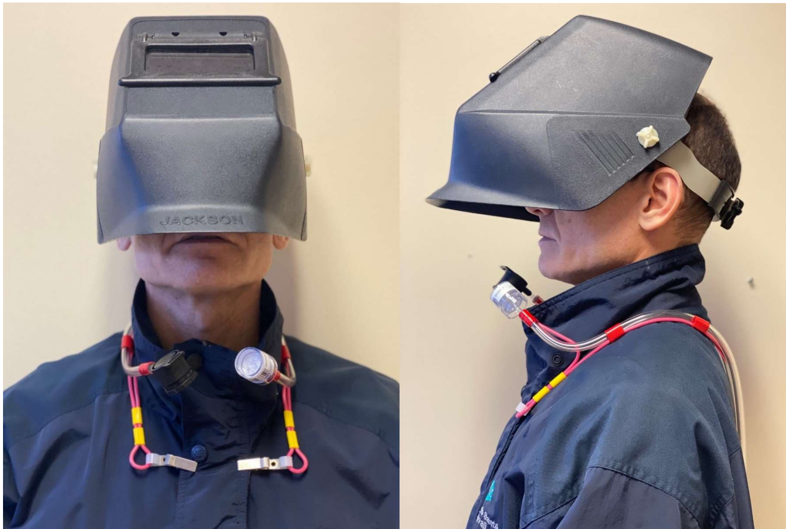
Figure 8 : Avec un dispositif/support de fixation et deux tubes Tygon simples (casque ouvert)
