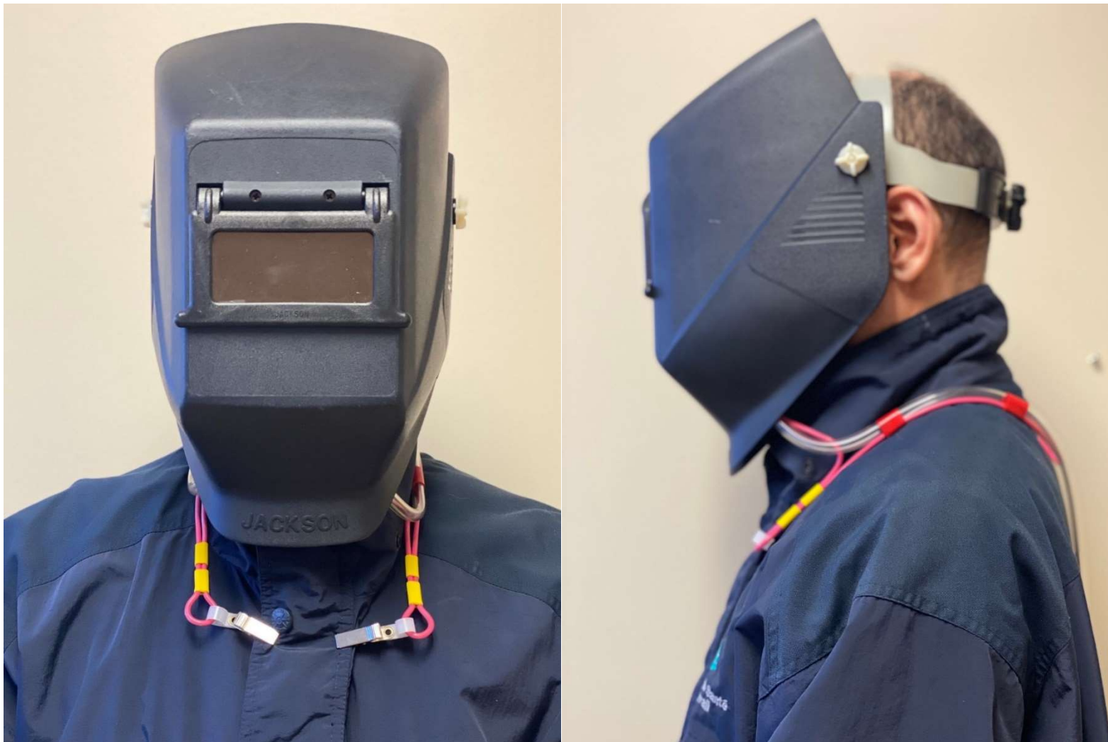
Figure 9 : Avec un dispositif/support de fixation et deux tubes Tygon simples (casque fermé)
