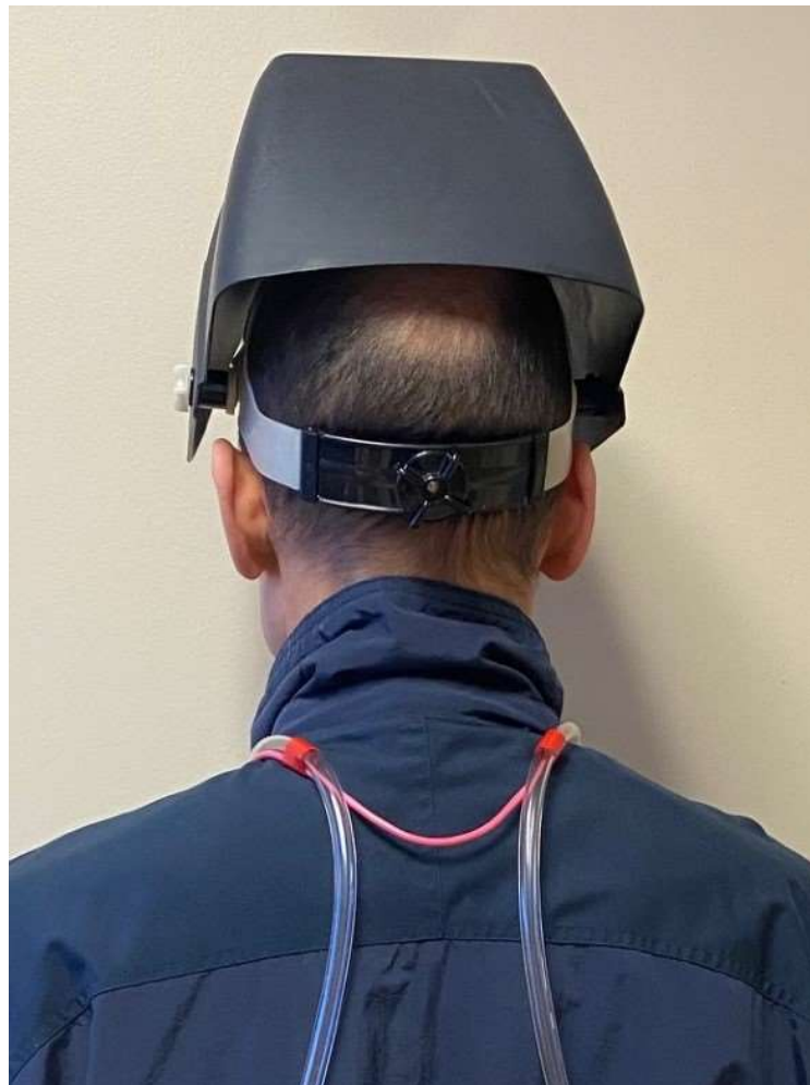
Figure 10 : Avec un dispositif/support de fixation et deux tubes Tygon simples (vue de dos)
