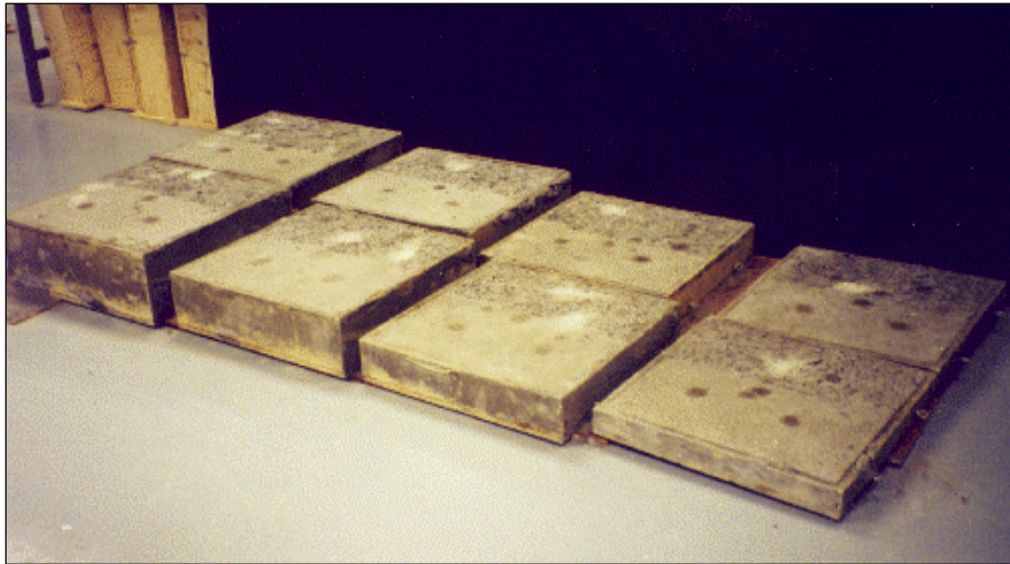
Figure 4.1: Les huit dalles soumises aux essais MSR Impact-Écho .
