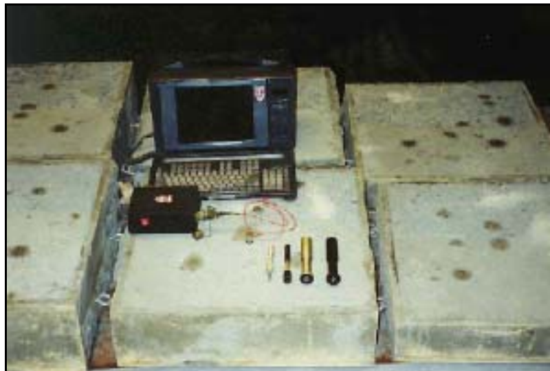
Figure 3.5: Système MSR Impact-Écho et les sources d'impact.
