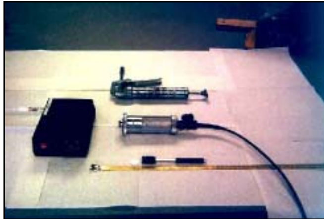
Figure 3.6: Système MSR Impact-Écho , le module comprenant le capteur et le conditionneur des signaux.
