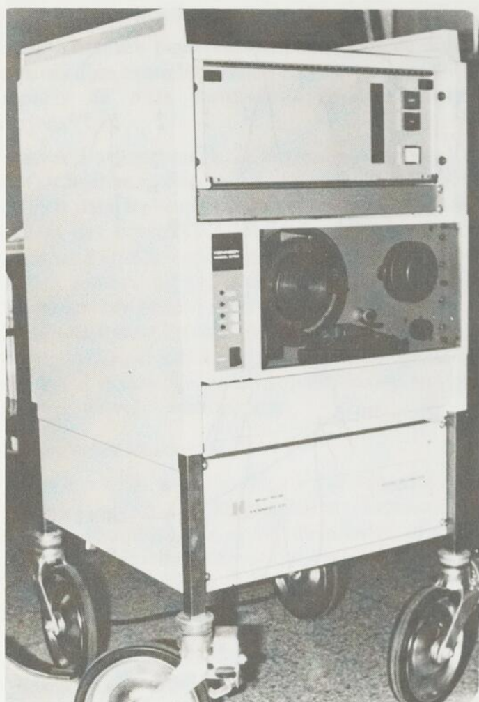
Fig. 3 — Vue d'ensemble du système d'acquisition de données conçu et réalisé par le Groupe en Instrumentation du Programme de génie biomédical, École Polytechnique et Faculté de médecine de l'Université de Montréal.
