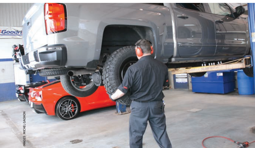
Ces images sont tirées d'une vidéo faite pour évaluer des tâches à risque. À partir de la grille d'analyse, vous pouvez voir qu'il y a inconfort parce qu'il faut mettre le genou au sol ou qu'il y a un effort excessif lorsqu'on soulève une roue de 40 kg (90 lb).
