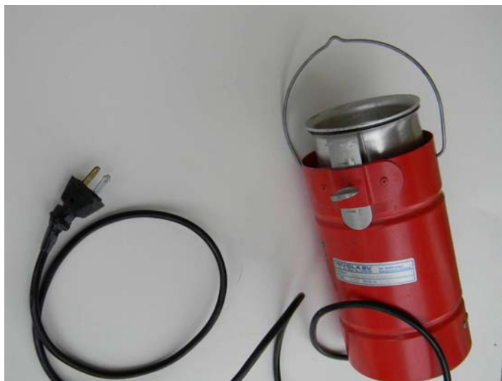
Photo 1 : Brûleur à soufre. Le soufre en poudre est déposé dans le récipient sur le dessus de l'appareil. Un élément chauffant à l'intérieur permet la sublimation du soufre contenu dans le récipient.
