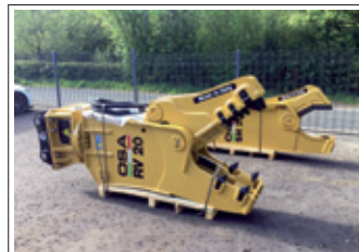
Pulvérisateur hydraulique OSA DEMOLITION EQUIPMENT, fait d'acier Hardox 400, hydraulic rotation 360°. Crushers 4 Sale Ltd paul@crushers4sale.com Téléphone: +44 (0) 7710 058 066
