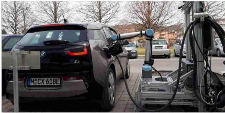
Figure 21 : Station de recharge électrique robotisée avec arrimage automatique
