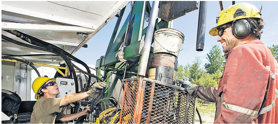
PHOTO ALAIN ROBERGE, ARCHIVES LA PRESSE Les foreurs Richard Lafrenière et Danny Larochelle font du carottage géologique dans les rues de Malartic afin d'évaluer la quantité d'or sous les résidences. La MRC de la Vallée de l'Or accueillera le mégaprojet de près de 1 milliard de la Société minière Osisko à Malartic.
