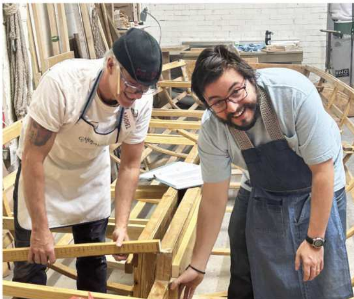
Michel et Orlando, du groupe du samedi, placent un renfort qui soutiendra le banc devant le puits de dérive.
