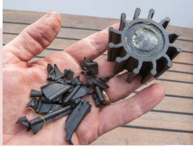
Pompe à l'eau brisée. Crédit photo : Umomos, Shutterstock.
