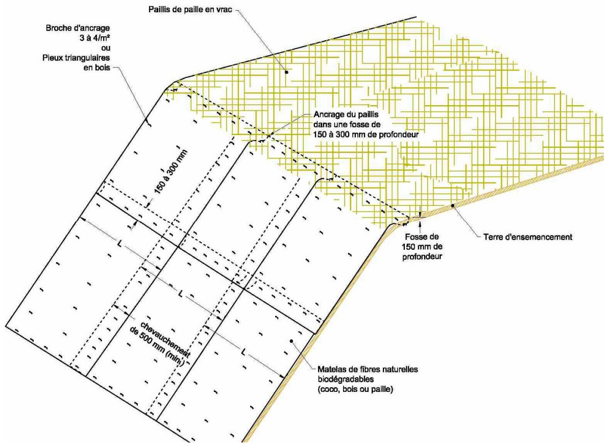
Figure 12 Mise en place des matelas de pailis
