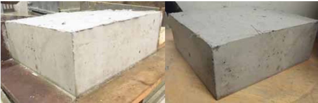
Figure 38 – Surfaces du spécimen coulé (BRF35-FA-0.5% avec section de treillis soudé) après décoffrage
