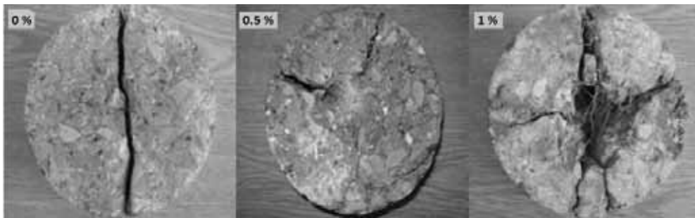
Figure 14 – Fissuration des spécimens sans fibres ou avec fibres d'acier après impacts en compression (pour 0, 0.5 et 1 % vol. de fibres) [48]
