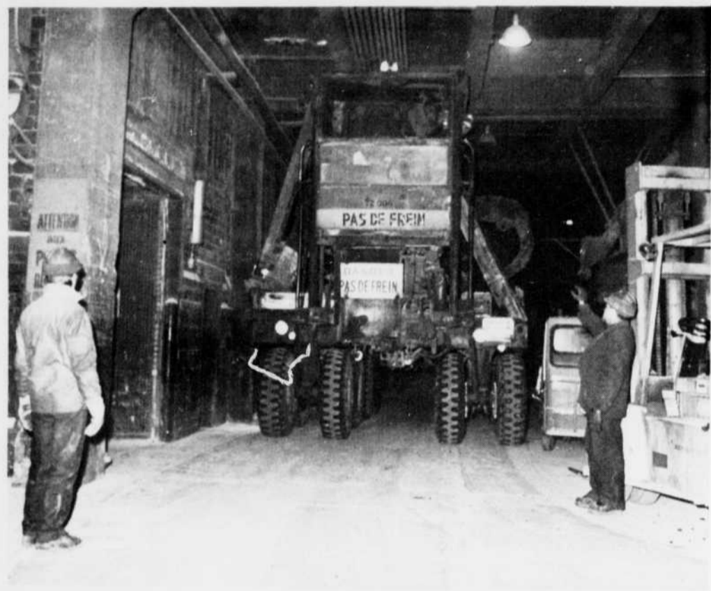
LE TRANSPORTEUR de cuves peut voyager dans le passage central des salles de cuves d'est en ouest et d'ouest en est alors que les autres camions ne doivent circuler que dans la direction ouest-est. Ce géant qui a 14 pieds de largeur doit avoir une voie
