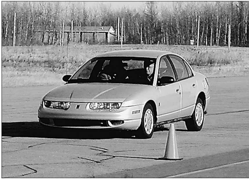
Freinage d'urgence avec le moteur emballé. Notez comment le poids est déplacé vers l'avant sous l'effet du freinage violent.
