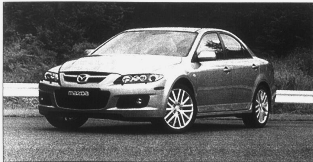
La Mazda6 Speed sera la plus puissante berline jamais construite par Mazda. Son moteur turbo de 2,3 litres développe une puissance de 274 chevaux et un couple de 280 lb-pi.
