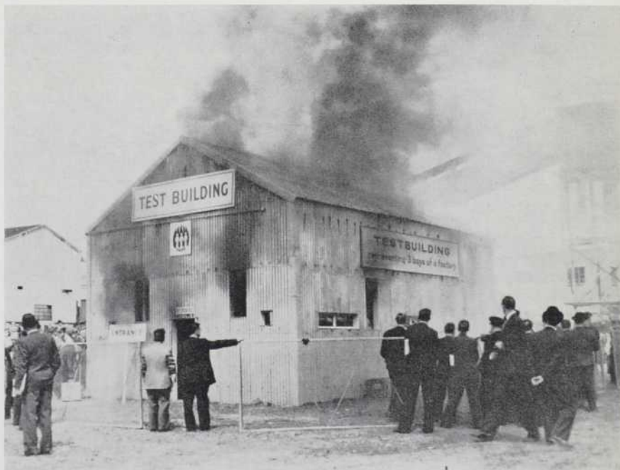
— Un essai de feu est en cours. Les murs intérieurs de l'immeuble d'essai ont été recouverts d'Asbestolux qui est resté intact après 40 minutes de feu.
