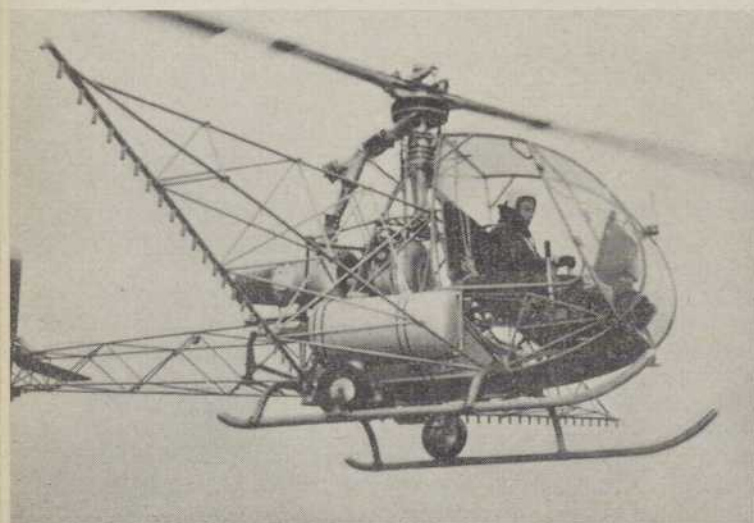
LE SO-1221 DJINN, ÉQUIPÉ DE RAMPES D'ARROSAGE POUR LES TRAVAUX AGRICOLES.
