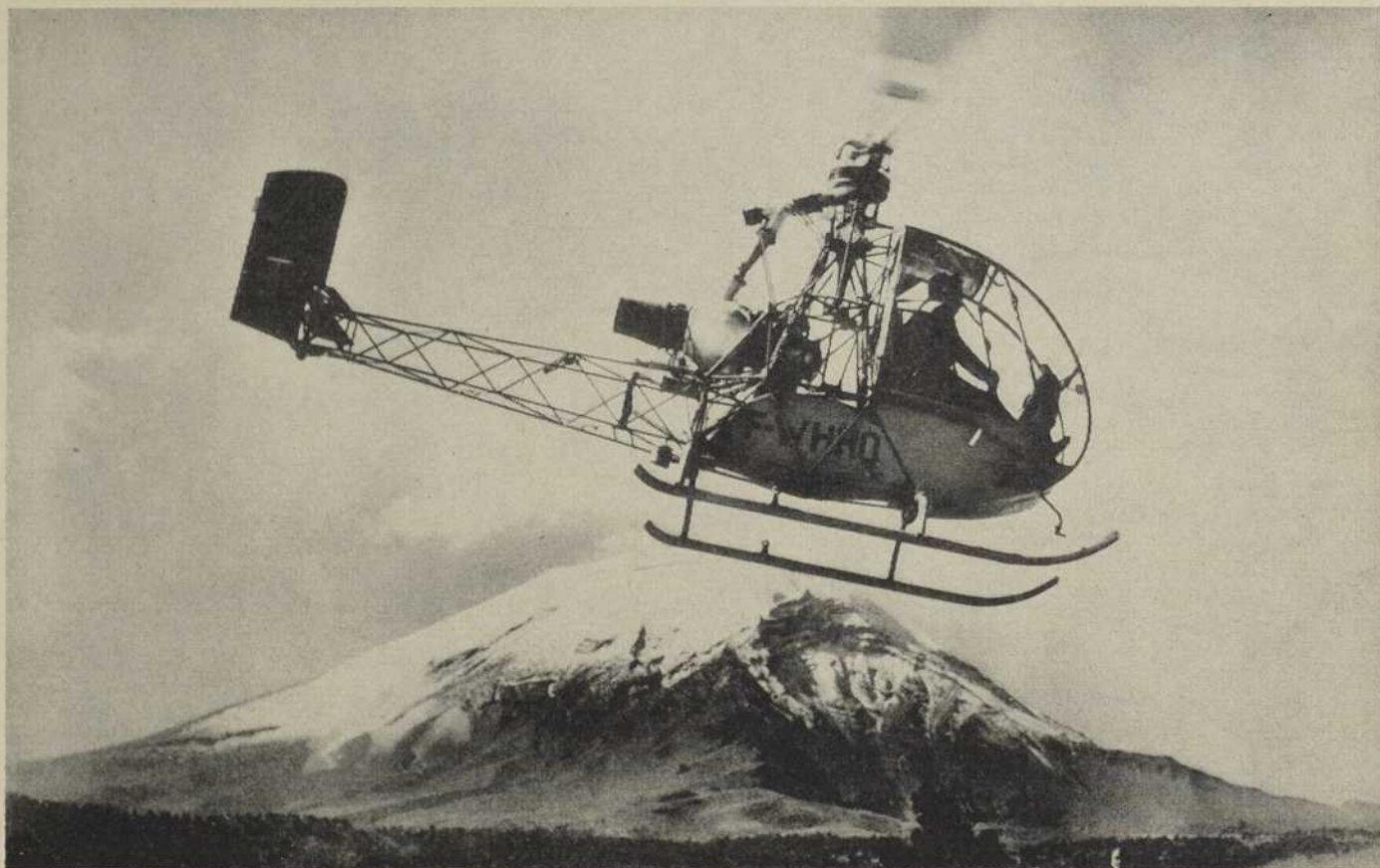
L'HÉLICOPTÈRE BIPLACE À RÉACTION SO-1221 DJINN, CONSTRUIT ACTUELLEMENT EN SÉRIE POUR LES BESOINS CIVILS ET MILITAIRES, A ÉVOLUÉ À UNE ALTITUDE DE 5,000 MÈTRES AU VOISINAGE DU POPOCATEPETL, AU MEXIQUE. IL DÉTIENT DEPUIS LE 22 MARS 1957 LE RECORD D'ALTITUDE POUR HÉLICOPTÈRES TOUTES CATÉGORIES, AVEC 8,482 MÈTRES.
