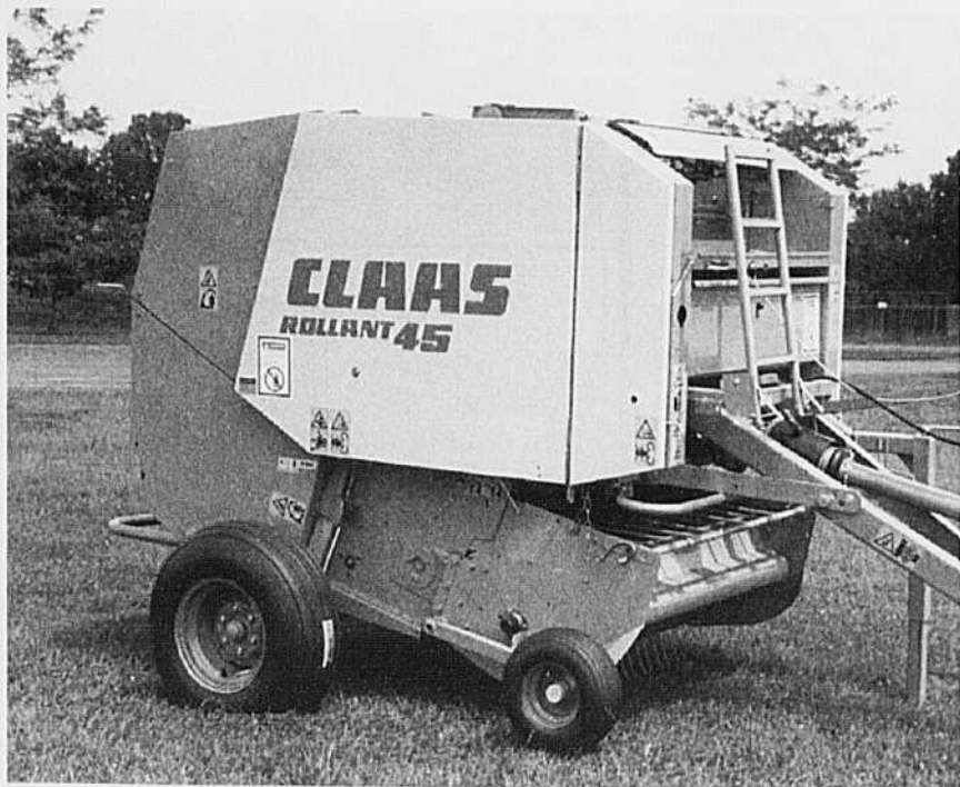
Une des deux nouvelles ramasseuses-presses de Claas Amérique, la Rollant 45 à chambre fixe à spirale produit des balles de 4 pi X 4 pi, à l'aide de rouleaux en acier striés.
