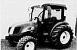
Tracteur NH T2420, 574 h, 50 HP ou PTO, 2 s. huile arr., valve au centre joystick, trons. 12x12 inverseur hydro.
