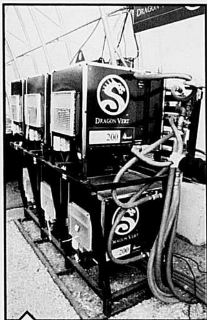
Une unité de diffusion de chaleur de ce type est suffisante pour chauffer une petite usine de 70 x 100 pi avec un plafond de 25 pi.
