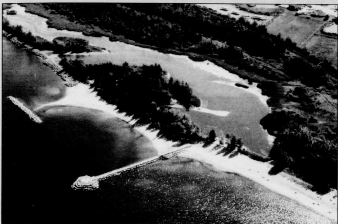
Épis, brise-lames et perrés au marais Le Rigolet à Métabetchouan.
