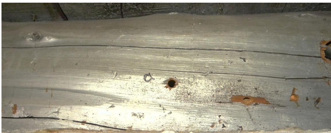
Photo 2. Surface de la poutre 23A-150a et position de la carotte prélevée.
