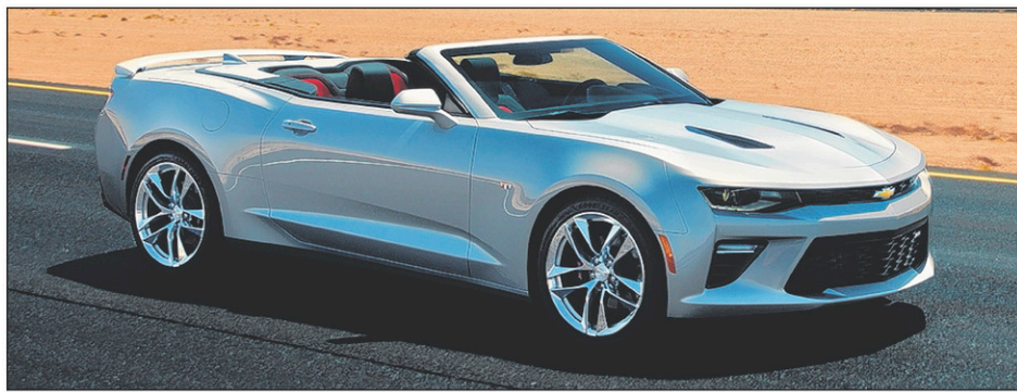
La nouvelle Chevrolet Camaro est animée par un L4 turbo de 2,0 l (275 ch), un V6 de 3,6 l (355 ch), un V8 de 6,2 l (455 ch) ou un V8 suralimenté de 6,2 l (640 ch).
