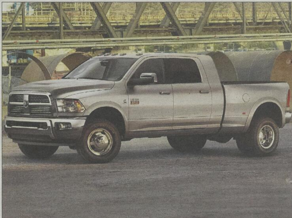
Pour rivaliser avec les nouveaux moteurs des camionnettes Ford Super Duty et GMC/Chevrolet HD, Ram a dévoilé un moteur Cummins plus costaud. Ce 6-cylindres de 6,7 litres développera un couple de 800 lb-pi capable de tirer une charge de 10 297 kg (22 700 lb).
