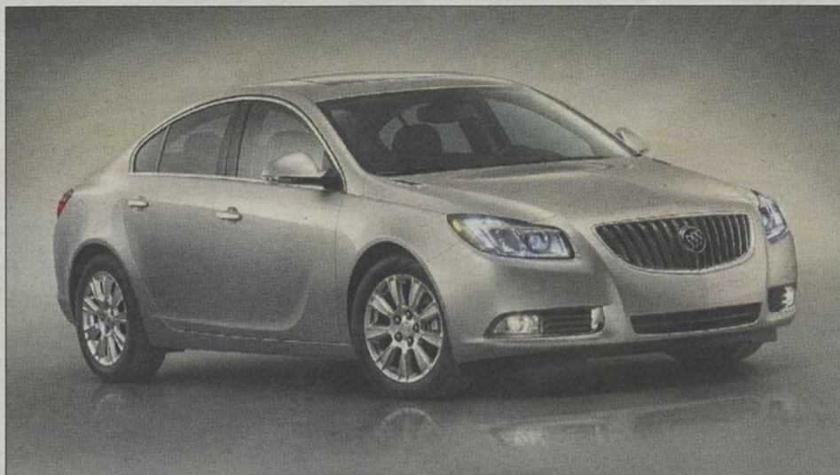
La Buick Regal 2012 sera offerte en version « eAssist » animée par une motorisation hybride dont le 4-cylindres de 2,4 litres sera jumelé à un petit moteur électrique de 15 kW.
