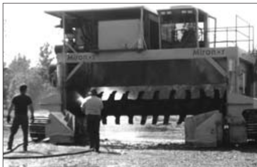
Cette méga machine remue efficacement et façonne les andains de compost.
