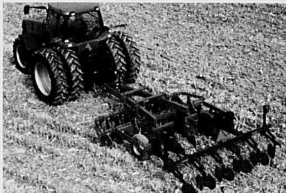
Écolo-tiger 530B. 5 dents à écartement de 30 po. Puissance nécessaire: 170 à 240 CV.
