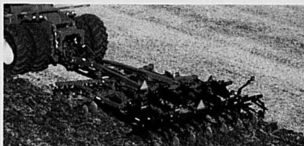
Écolo-tiger 730B. 7 dents à écartement de 30 po. Puissance nécessaire: 245 CV et plus.
