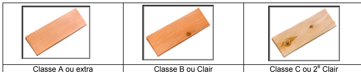
Photo 14 : Attributs typiques des classes de qualité A, B et C de bardeaux réguliers
