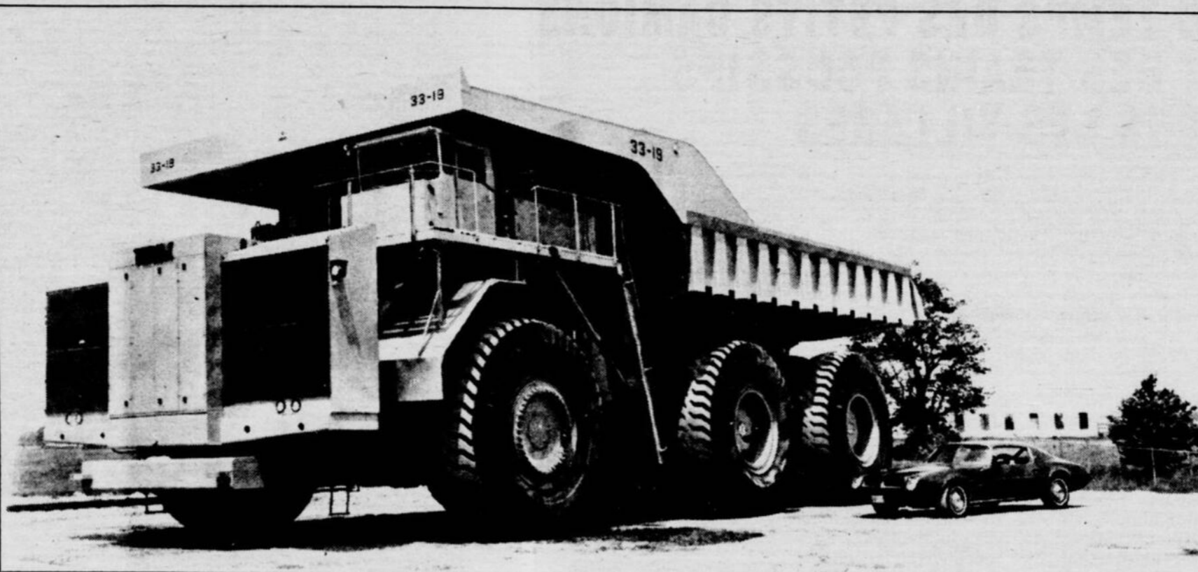
Le plus gros camion jamais construit en Amérique: le haulier Titan Terex à moteur diesel-électrique, d'un poids à vide de 255 tonnes et capable de transporter un chargement de 350 tonnes. Long d'à peu près 67 pieds, il tire sa propulsion d'un moteur diesel-électrique GM de 3,000 c.v. au frein. Ce mastodonte sert dans des régions canadiennes où on se livre à l'exploitation minière à ciel ouvert.
