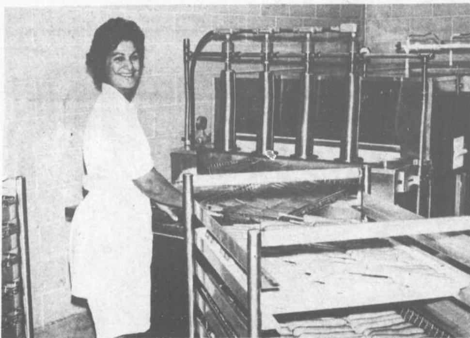
L'une des étapes les plus importantes pour la conservation des pogos est sans doute la réfrigération. Cette machine les congèle à -80 degrés Fahrenheit! Tant qu'au sourire de cette belle dame, disons qu'il est plutôt réchauffant...
