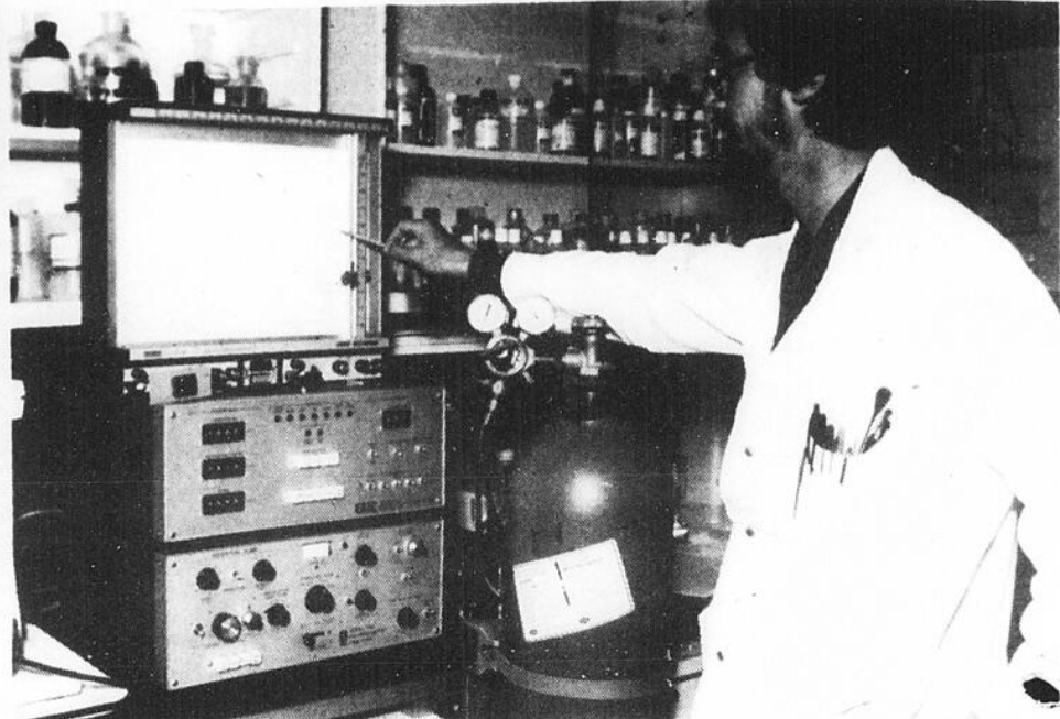
Le polarographe permet de mesurer des concentrations de métaux lourds tels le plomb ou le cadmium, susceptibles de menacer la chaîne alimentaire, à la concentration de l'ordre de la partie par milliard.
