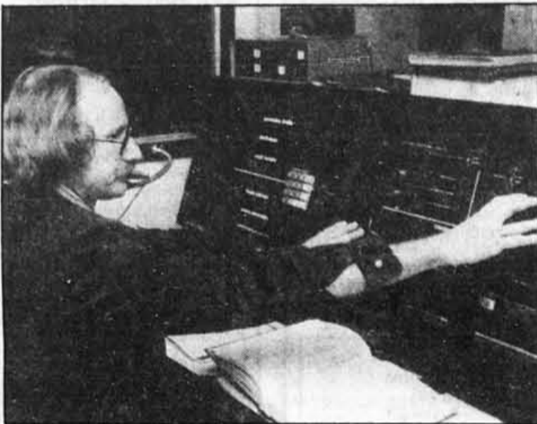
De la console de commande, Ghislain Turcotte, technicien, fait bouger le télescope selon deux axes de rotation qui permettent d'atteindre n'importe quel point dans le ciel.
