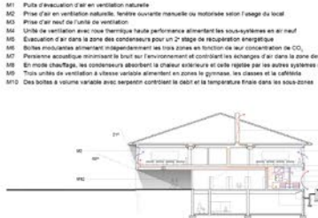
Schéma des principes de mécanique
