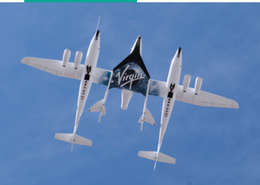
▽ Ci-dessous : L'appareil SpaceKnightTwo — un fuselage double, une envergure de 43 m, et quatre moteurs d'avion à réaction — avec l'avion spatial SpaceShipTwo arrimé en son centre. Crédit photo : Virgin Galactic.
