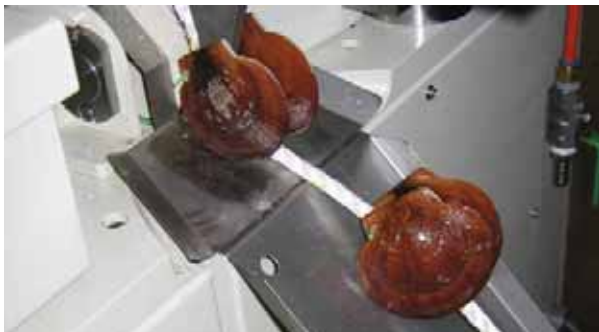
Élevage automatisé de pétoncles en boucles d'oreilles avec l'équipement « mimitsuri ».
