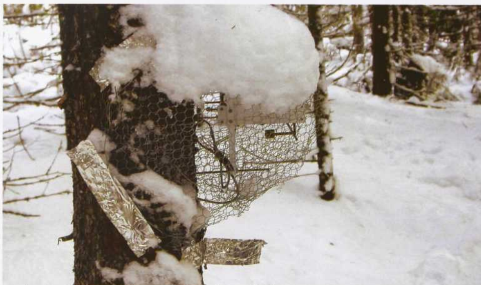
Dendromètre électronique qui mesure les fluctuations en diamètre du tronc toutes les 15 minutes.
