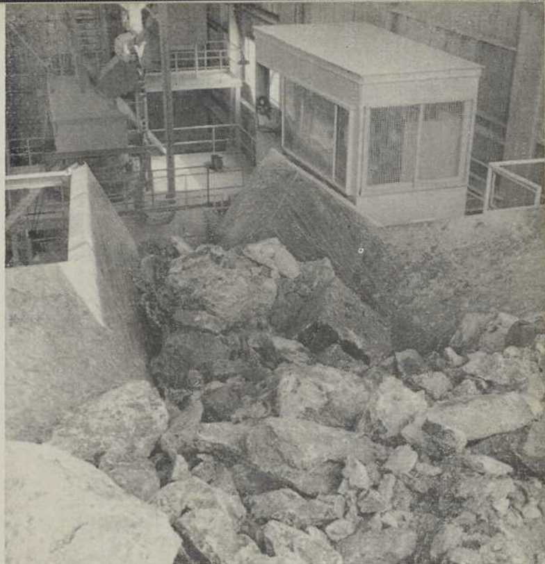
TRANSPORTE PAR CAMIONS, LE MINERAI EST VERSE DANS UNE CHUTE QUI ALIMENTE LE CONCASSEUR.
