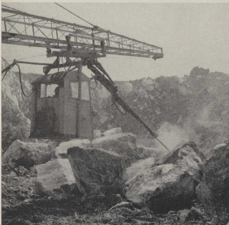
ON UTILISE DES FOREUSES MOBILES MONTÉES SUR CHENILLES POUR PRATIQUER LES TROUS NECESSAIRES AU DYNAMITAGE.
