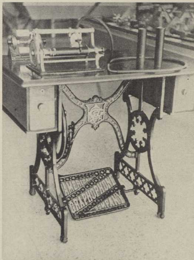
Un des premiers phonographes commerciaux fabriqués par l'« American Graphophone Co. », maison que Thomas Edison aurait fondée vers 1880. Comme on le voit, l'énergie humaine fournissait la force motrice au cylindre, rappelant ainsi la machine à coudre.
