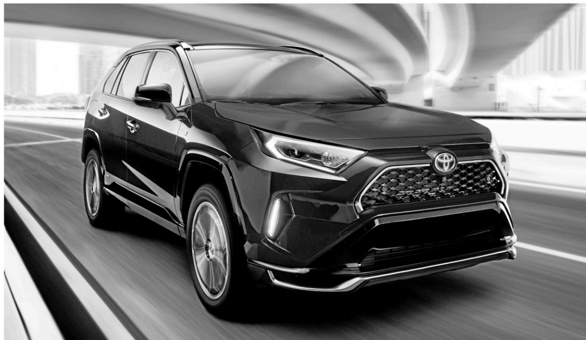
Un véhicule qui sera sûrement populaire lors de sa sortie prévue au milieu de 2020, le VUS RAV4 Prime de Toyota. Sa batterie de 17 kWh permettra de rouler 63 kilomètres en mode électrique avec une charge, avant que le moteur à essence ne prenne le relais. — PHOTO FOURNIE PAR TOYOTA
