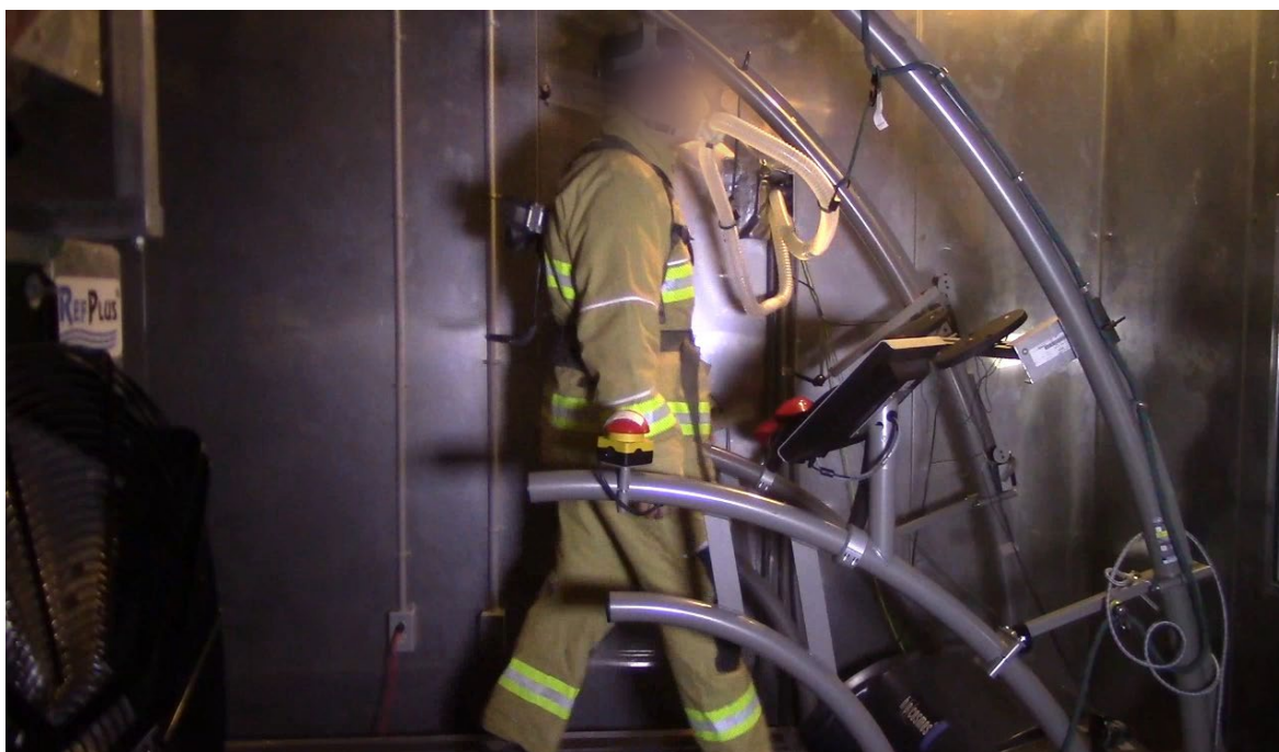
Figure 6. Vue d'un participant instrumenté et de l'équipement à l'intérieur de la chambre climatique
