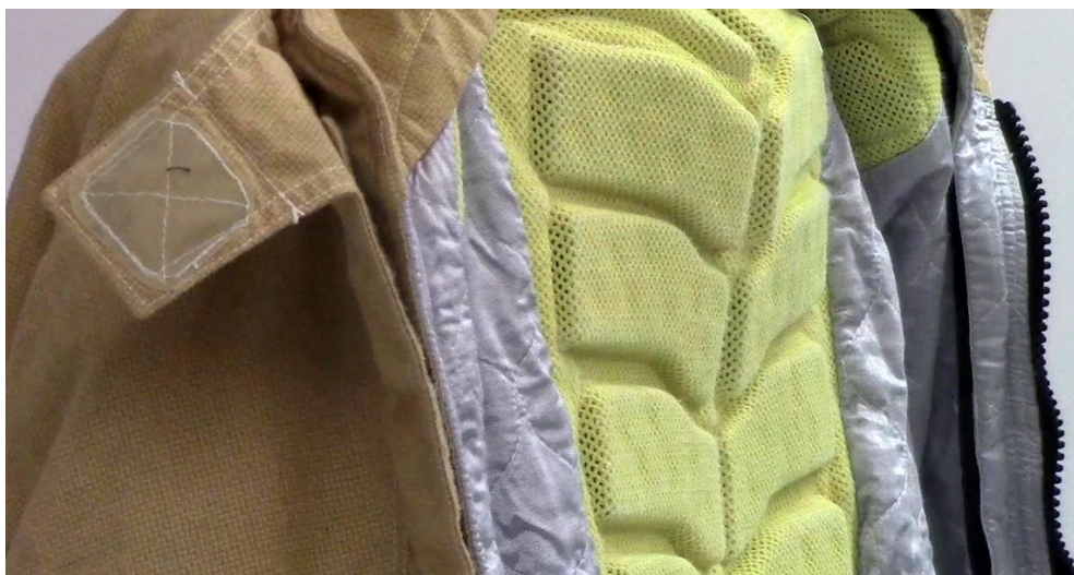
Figure 5. Vue intérieure d'un VIP équipé du système d'aération
