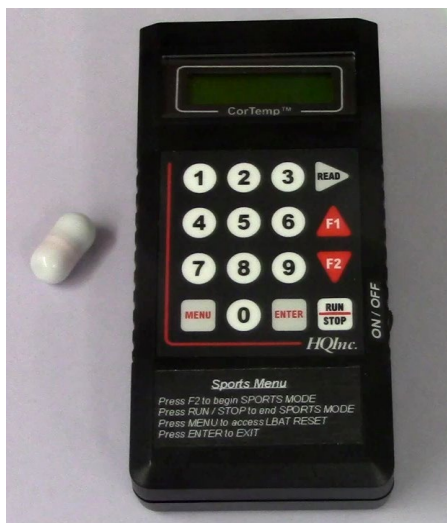
Figure 8. Système utilisé pour les mesures de la température interne (à gauche) et un exemple de résultats obtenus pour un participant lors d'un test (à droite)
