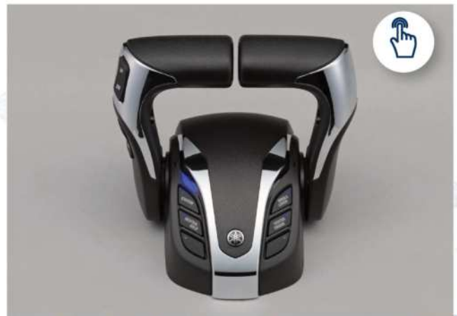
Les différentes manettes-joysticks du Helm Master EX de Yamaha.
