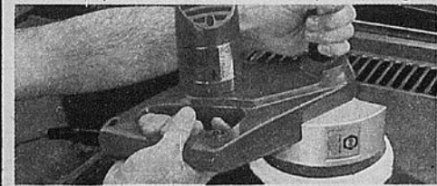
POUSSEUSE. Coiffe à polir se fixant au disque coussiné pour polissage de voitures ou de meubles.
