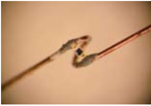
Fig. 3 Diode de Schott collée sur une boucle de fil de cuivre.
