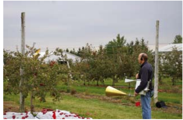
Fig. 5 Opérateur de radar harmonique balayant un pommier avec un radar harmonique pour retrouver un charançon de la prune adulte sur lequel une antenne électronique a été collée.
