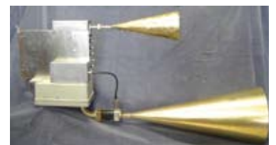
Fig. 2 Unité de radar harmonique, vue de profil. Le cône inférieur est émetteur, alors que le cône supérieur reçoit le signal.
