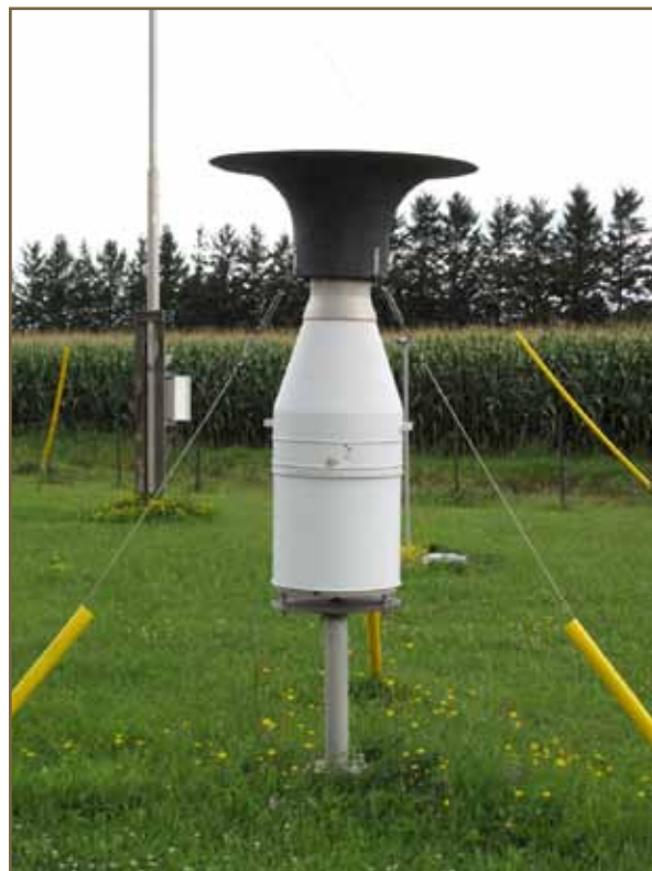
FIGURE 5. PLUVIOMÈTRE À PESÉE
