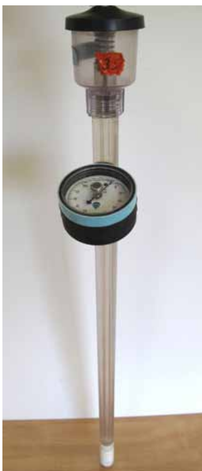
FIGURE 9. TENSIOMÈTRE AVEC EMBOUT EN CÉRAMIQUE
