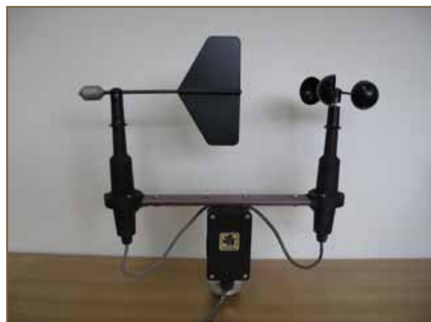
FIGURE 7. GIROUETTE ET ANÉMOMÈTRE À COUPELLE ÉLECTRONIQUE
